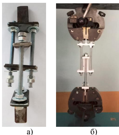
Рисунок 1: а) приспособление для испытания на сжатие; б) приспособление с образцом в разрывной машине
